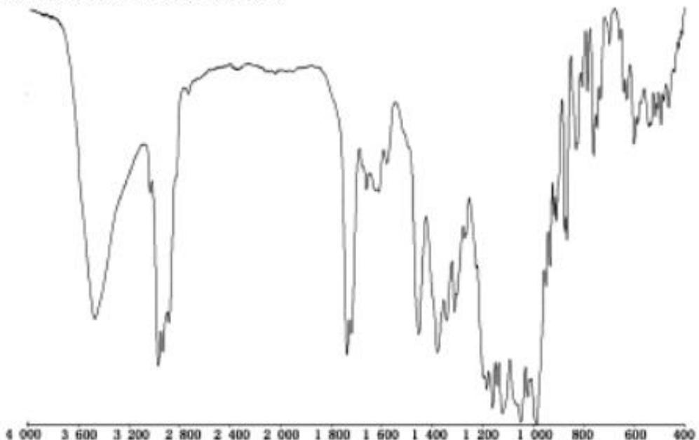
图 1 阿维菌素标样的红外光谱图
